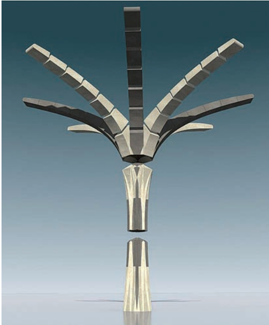
L'arbre "magique" construit par les stagiaires après l'étude stéréotomique numérique précise de ses différents éléments.
