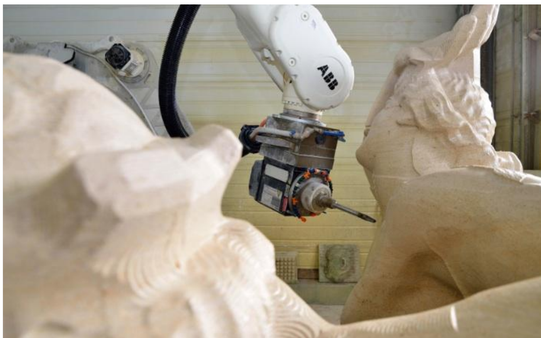
Acheté en 2015, ce robot de taille est la troisième acquisition de ce type réalisée par l'entreprise. Il est capable d'usiner entièrement une statue à partir d'une pièce originale numérisée. ©Frédéric Marais / Agence Info.
