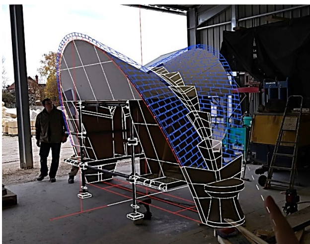
Vues, en détail et générale, des calques projetés en réalité mixte
